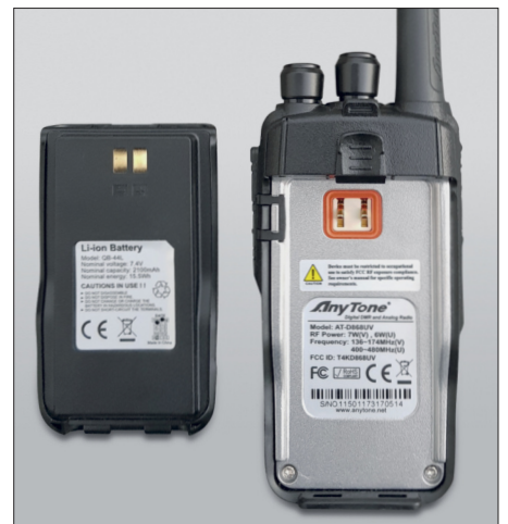
Rückseite des Geräts, Akkumulator abgenommen Fotos: DL1YBL
