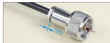
Bild 4: Verschlusschraube von Hand anziehen, mit Maulschlüsseln 11 mm und 12 mm festziehen (1 mm Spalt lassen), Innenleiter bündig abschneiden und anlöten.
