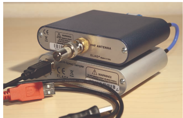
Bild 2: Rückansicht mit Adapter für SMA-BNC (mitgeliefert) und für BNC-IEC (nicht mitgeliefert)
