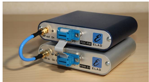
Bild 1: Vorderansicht des ELAD FDM-S1 (unten) und PDC-FM (oben)
