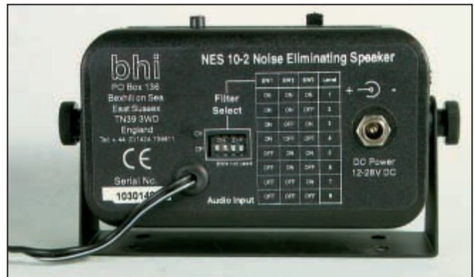
5 - Le réglage du niveau de réduction se fait à l'aide d'un DIP-switch.
