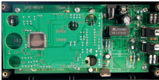
2 - Au premier plan, le circuit intégré DSP.
