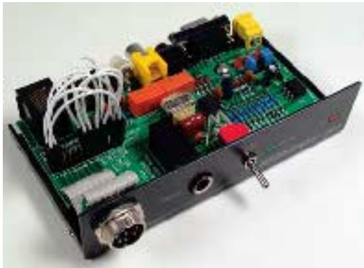
Das RIGblaster Plus geöffnet. Der VOX/Auto-Schalter bestimmt den PTT-Betriebsmodus. In Stellung „VOX“ steuert die Sende-NF des Computers die VOX des Transceivers. Eine eigene VOX enthält das Plus nicht.
