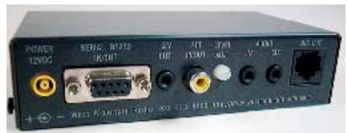
Die rückseitigen Anschlüsse des RIGblaster Plus. Einen Ein-Aus-Schalter besitzt das Gerät nicht, der Stromverbrauch ist sehr gering.
