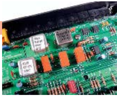
Blick auf die Übertrager und Relais im RIGblaster Pro.
