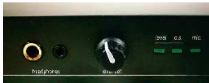
Der Pegelsteller regelt die Amplitude des Sendesignals, die Level-LED leuchtet im Takt des NF-Signals. Beide Kopfhörerbuchsen dienen zur akustischen Kontrolle des eigenen Signals.
