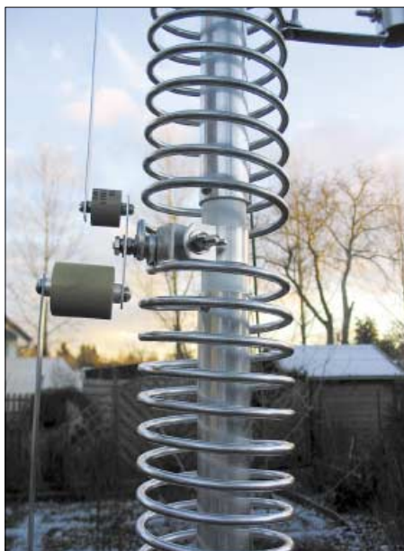
Bild 4: Detail Spulen mit Kondensatoren für 80 und 40 m
