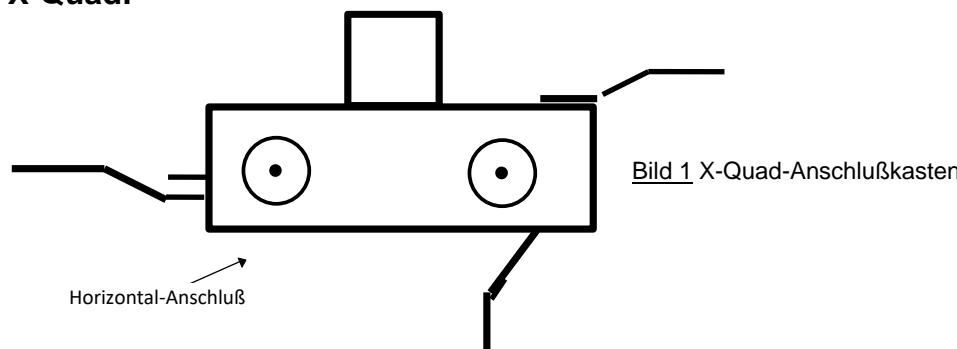
Die Antenne muß mit nach hinten zeigenden N-Buchsen und mit horizontal liegendem Anschlußkasten montiert werden (Bild 1).
