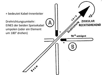
Bild 2 Drehsinn beim Kreuzdipol
