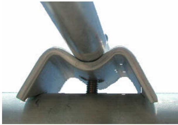
Bild 5: Schrauben für Elementklammern nur soweit festziehen!
