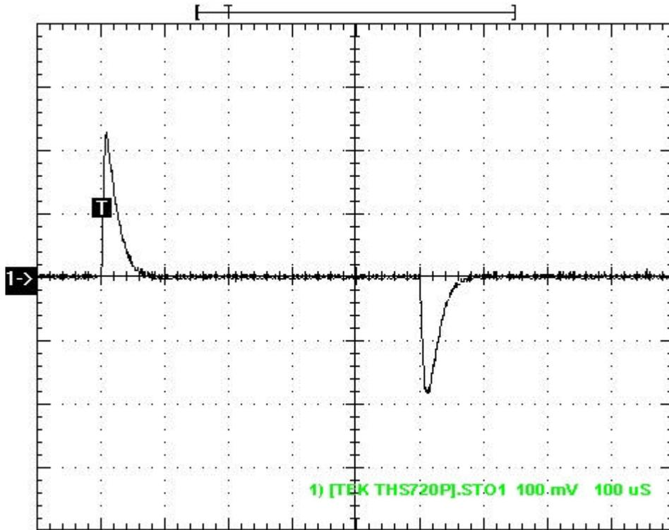
Bei Lastabwurf 32A auf 16A liegt der Spannungssprung des Ausgangs um +230mV, bei Lastsprung 16A auf 32A der Einbruch um -180mV. Die Ausgangsspannung wird vom Regelverstärker sauber rückgestellt, kein Überschwingen, kein hochfrequentes „Klingeln“ der Ausgangsspannung. Mit dieser hohen Phasenreserve ist die Stabilität des Regelverstärkers mehr als gewährleistet.
