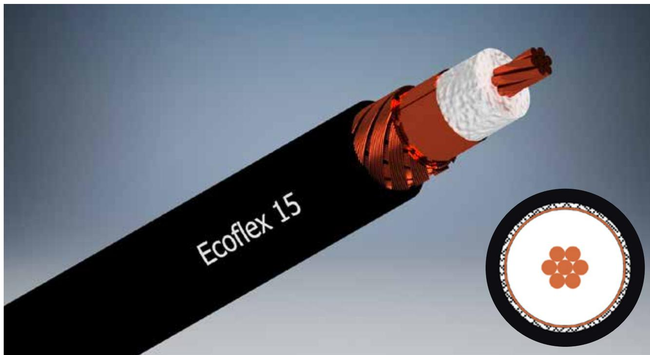
Ecoflex 15 ist ein flexibles und dabei sehr dämpfungsarmes 50 Ohm Koaxialkabel für den Frequenzbereich bis 6 GHz. Modernste Produktionsverfahren und die Verwendung eines verlustarmen PE-LLC-Dielektrikums mit einem Gasanteil von über 70 % ermöglichen geringe Dämpfungswerte.
