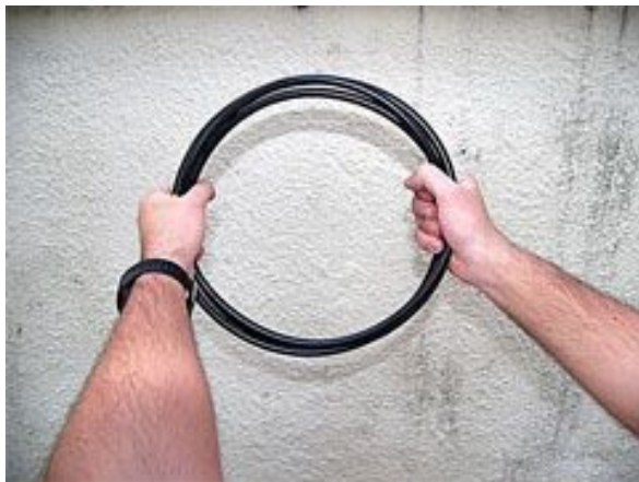
ケーブルが円形になるように形を整え、帯を解きます。
