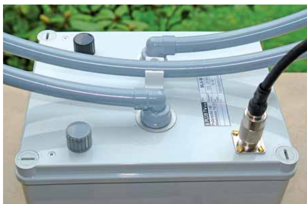
Bild 1: Schaltbox mit Bedienelementen und SO-259-Anschluss
