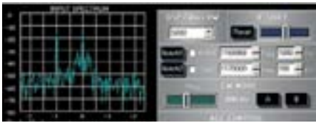
Das Spektrumdisplay zeigt die Situation rund um die Mittelfrequenz. 1 kHz unterhalb der Mittelfrequenz ist hier ein kräftiger Störträger zu sehen, der auf der Nutzfrequenz für Interferenzpfeifen sorgt.
