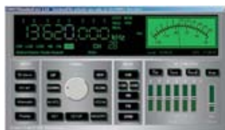
Das Cockpit des FDM77. Von hier werden alle Funktionen per Mausklick und/oder Tastatur gesteuert. Über Schaltflächen sind Untermenüs mit weiteren Funktionen zugänglich.
