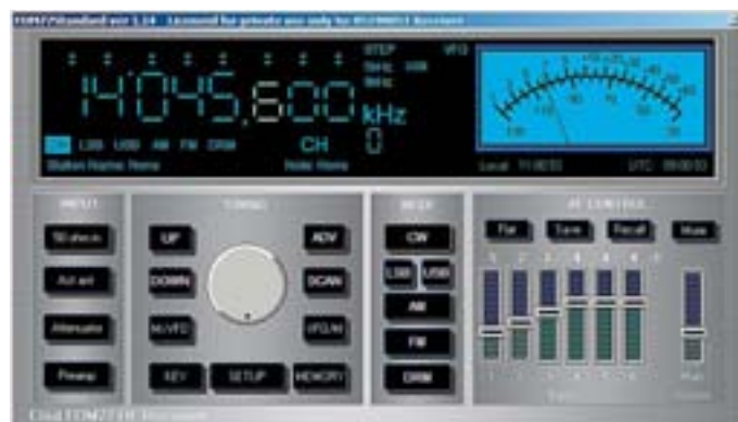
Empfänger der Zukunft schon heute: Der FDM77 wird komplett per Software bedient und gesteuert.
