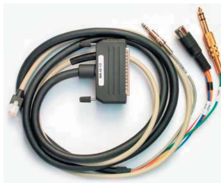
Als Zubehör bietet MicroHam fertig konfektionierte Anschlusskabel an. Wer selbst zum Lötcolben greifen will, findet detaillierte Anschlusspläne auf der Internetseite des Herstellers.
