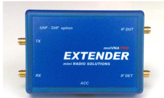
Der **EXTENDER** ist speziell für den **mini-VNA PRO** entwickelt worden und wird über die beiden mit IF DUT und IF DET SMA Anschlüsse mit dem Gerät verbunden. Das Gerät wird direkt vom mini-VNA PRO aus dem Zubehör Anschluss über ein gemeinsames CAT5-Kabel (mitgeliefert) mit Strom versorgt.
