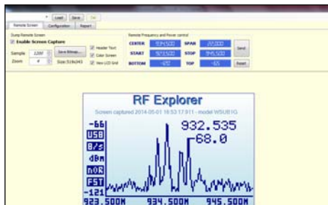
Screenshots von mit dem RF-Explorer aufgenommenen und ausgewerteten Signalen
