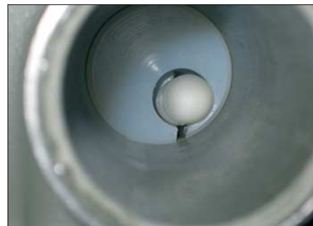
Bild 3: Hier sieht man im Boden vom Elemente-Aufnahme-Stützen der Elementegehäuse (Bild 2) – bei vollständig eingefahrenem Elementeband – den weißen Bandkopf, der das reibungslose Ausfahren des Kupfer-Beryllium-Bandes sichert.
