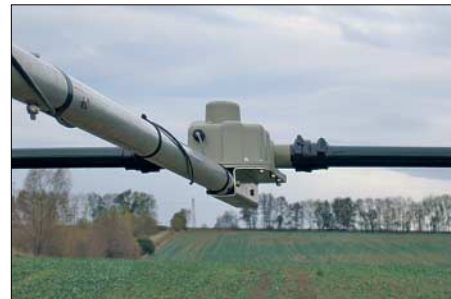
Bild 10: Steuerkabel um den Boom, ...
