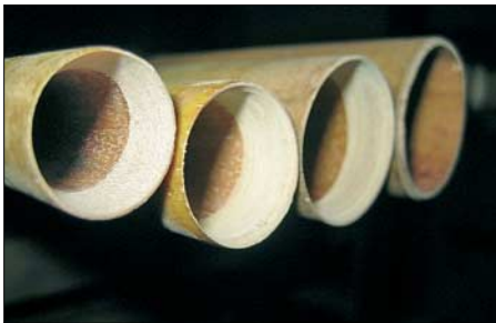
Bild 14: Die drei dünneren Rohrsegmente nach erfolgreicher Bearbeitung
