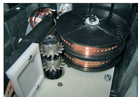
Bild 6: Aufgerollte Elementebänder mit den beiden Transportritzeln und der vertikalen Bandführung
