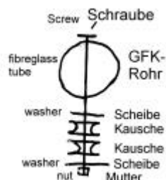
Vorbereitung der GFK-Enden
